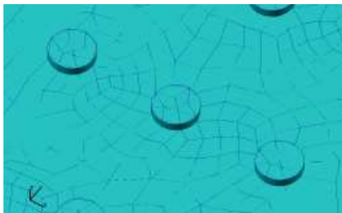
Figura 4.9 – Detalhe do modelo do rebite simplificado no modelo completo
